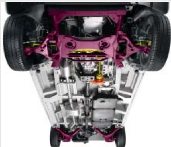
► Если Вам часто приходится ездить в тяжелых дорожных условиях, рекомендуем остановить выбор на автомобиле с постоянным полным приводом 4MATIC<sup>2)</sup>. Распределение тягового усилия между мостами в соотношении 35 : 65 улучшает сцепление с дорогой даже на скользком грунте.
