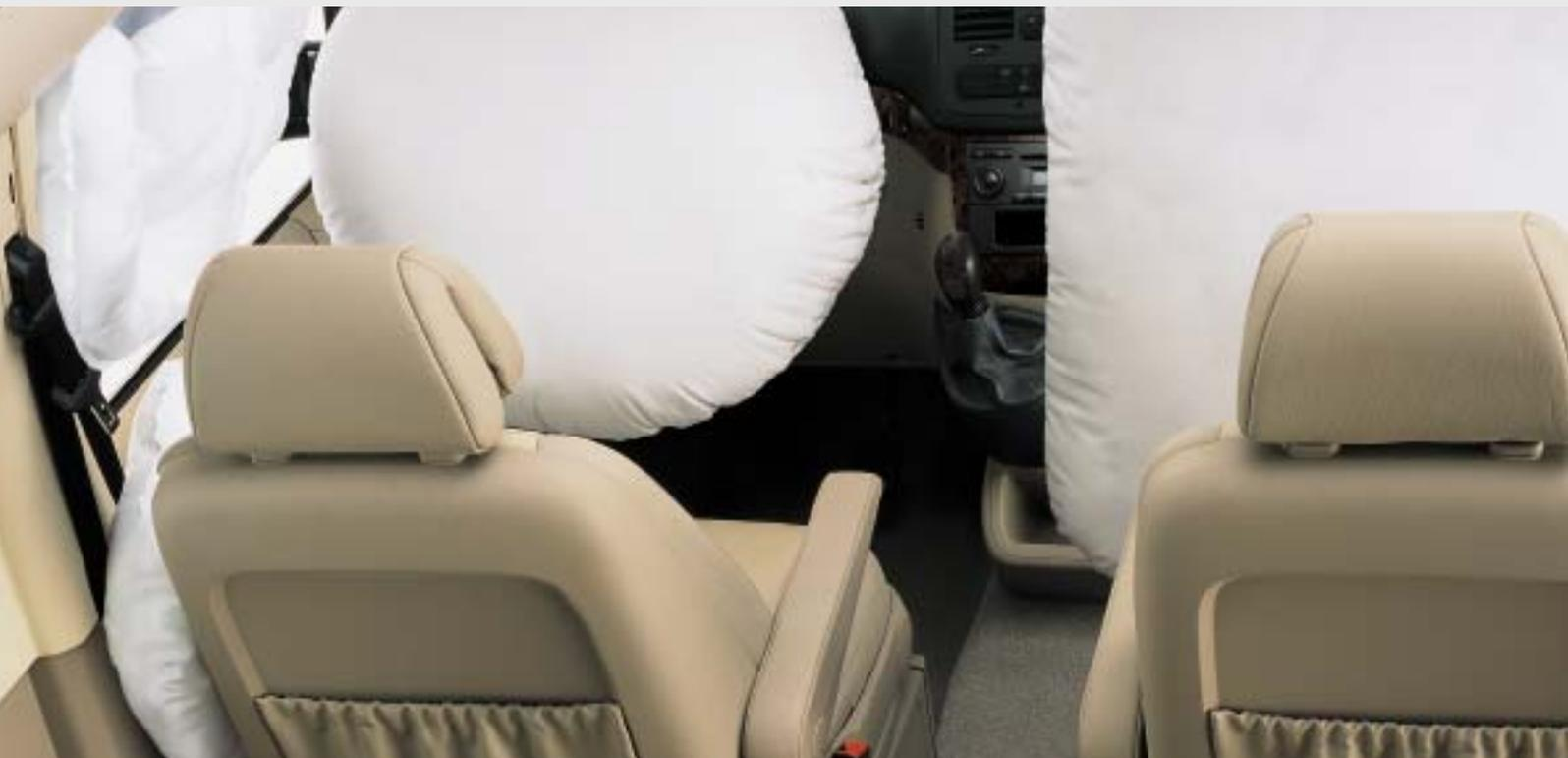
К числу множества конструктивных элементов и систем безопасности, сведенных в Viano в единую концепцию обеспечения безопасности, относятся также: травмобезопасная рулевая колонка, трехточечные ремни безопасности на всех местах, натяжители ремней водителя и пассажира, сигнализация пристегивания ремней. Базовая комплектация включает подушки безопасности водителя и пассажира, а также систему распознавания занятости места переднего пасса-
